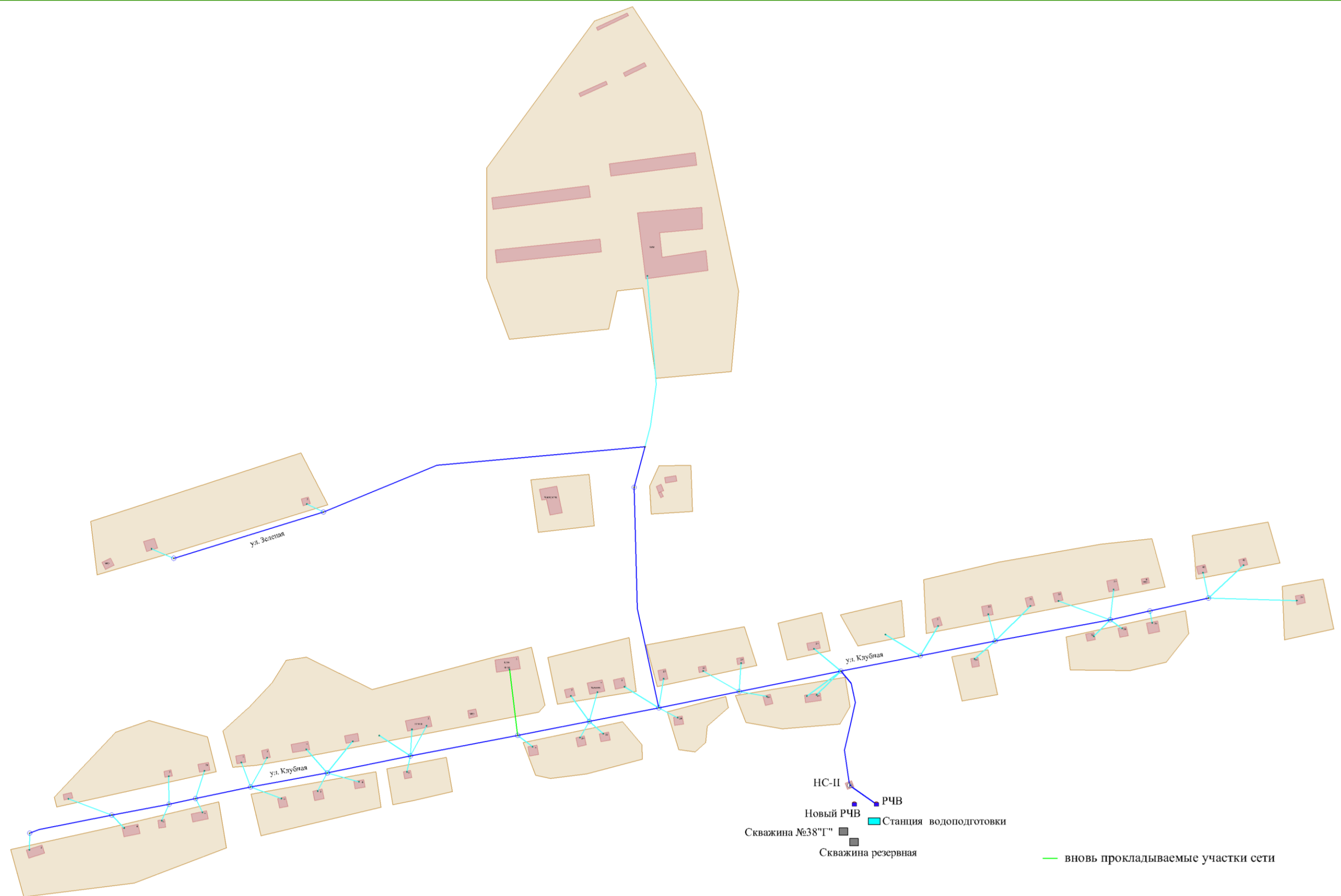
Рисунок 5.3 – Схема планируемого размещения объектов централизованной системы водоснабжения
