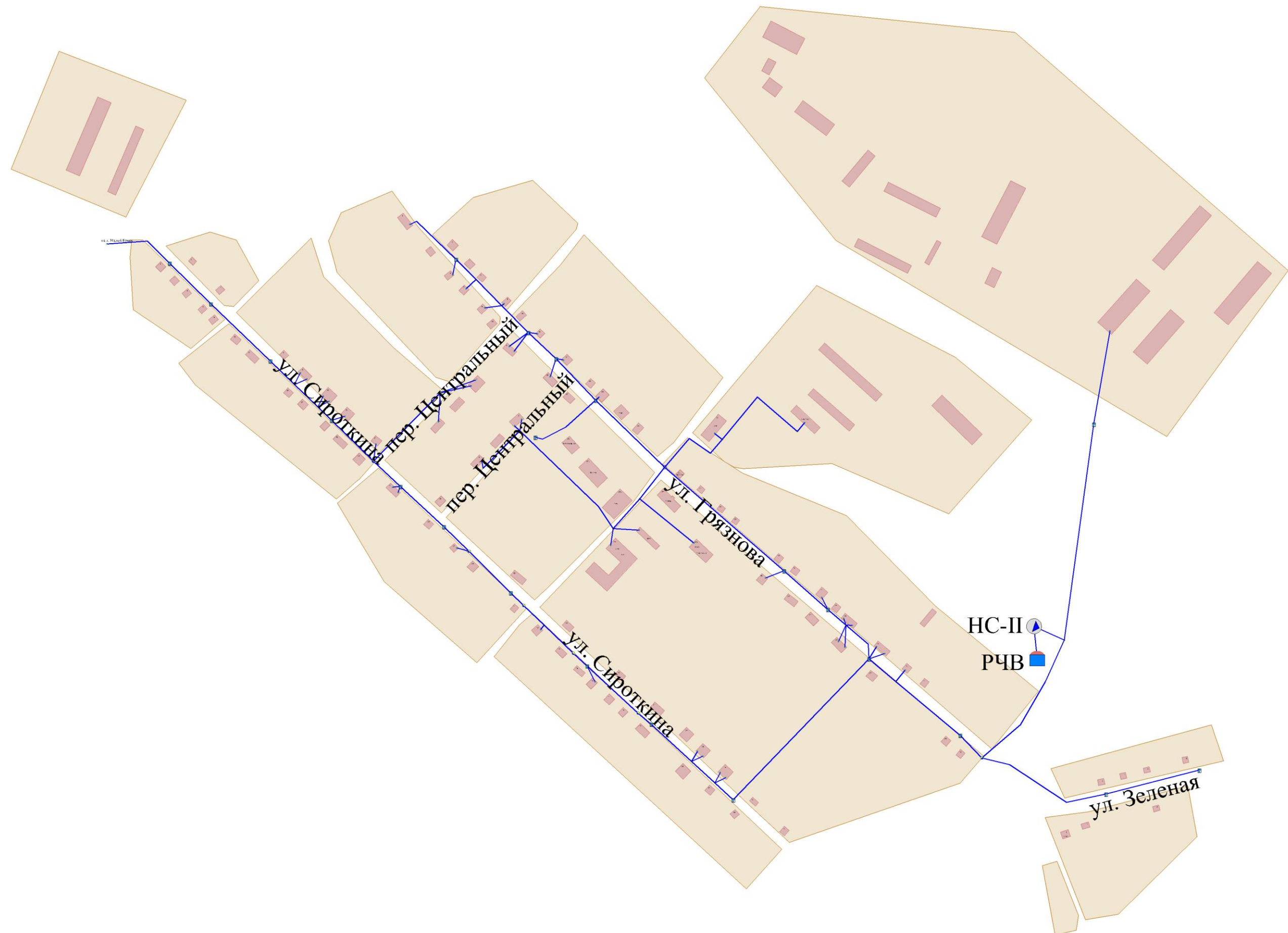
Рисунок 2.1 – Зона централизованного водоснабжения с. Козловка
