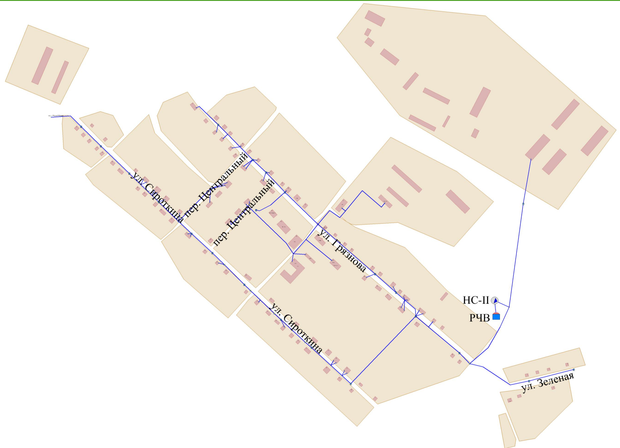
Рисунок 5.2 – Схема существующего размещения объектов централизованной системы водоснабжения
